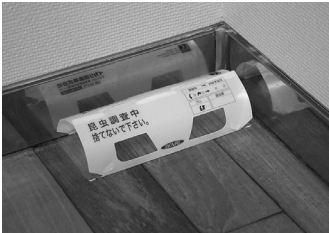
館内に侵入してきている昆虫を調べるトラップ 毎回およそ100ヶ所に設置して調査します
