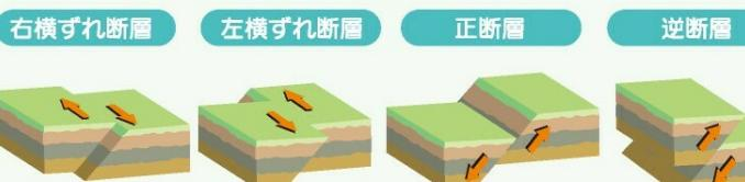
地下の岩盤に、押し合う力や引っ張り合う力が加わることで内部にひずみのエネルギーが溜まり、これが限界に達したときに、ある面(断層面)を境に地盤がずれ動き、地震が起ります。
