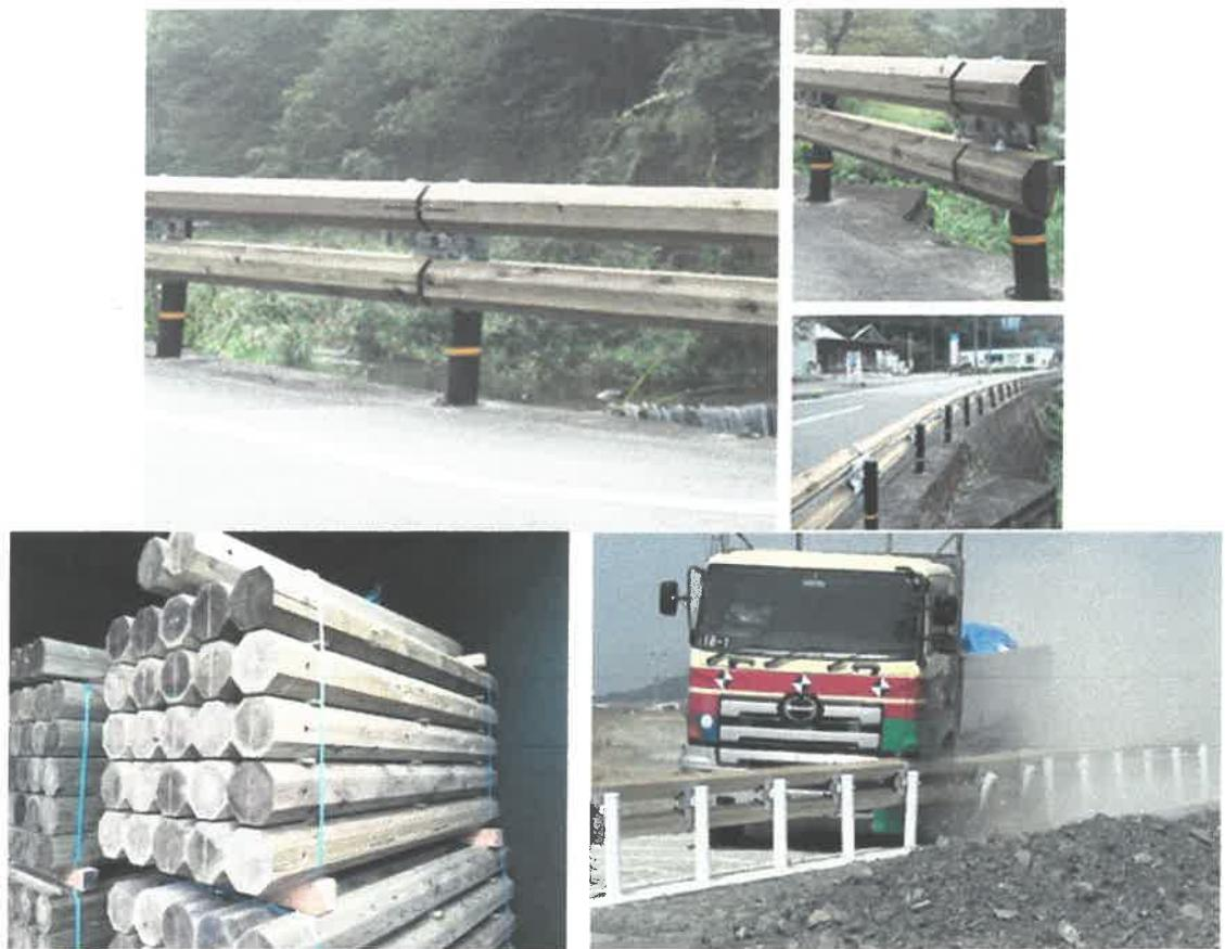
平成30年4月、(一財)土木研究センターによる木製防護柵性能確認試験に合格。トラックを衝突させる防護柵の強度確認試験、さらに乗用車を衝突させるドライバーの安全確認試験の二種類の試験に合格。(加太コスマパークにて試験実施)
