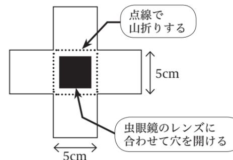
②作成したものを、内筒の先端に両面テープで取り付ける。
