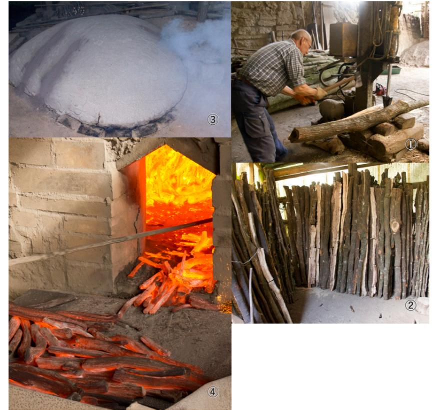
①太いウバメガシは、細くするために機械や斧を使って割ります。②曲がったものは切れ込みを入れ、その間に木片を挟みこみ、真っ直ぐなるように立てています。③煙が出ている窯の天井にある尻穴ひあな。煙の色と匂いで窯の中の状態が分かるそうです。④窯入れから約10日間で窯出しです。⑤叩くと「キーン」と心地よい音を出す紀州備長炭
