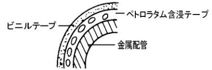
図24 防食テープによる覆装の例
