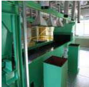
圧縮梱包機計量器付駆動コンベア
