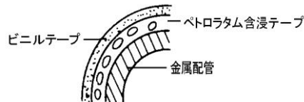
図24 防食テープによる覆装の例
