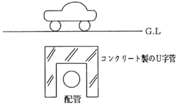
2 給油取扱所において、危険物を取り扱う配管として用いる合成樹脂製の管に次の保護措置が講じられている部分について、地盤面上を走行する車両による活荷重が直接配管に加わらない構造のものとして、当該車両からの活荷重によって生ずる応力を考慮しなくてよいこと。(H30 危42)
