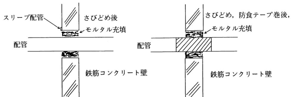
例図2 配管の固定装置の部分
