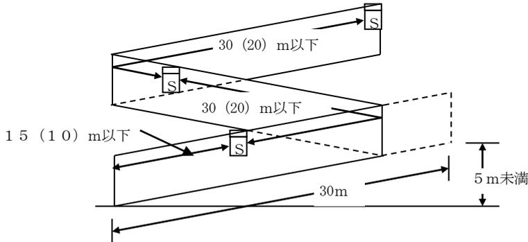
エ 下階と上階との階段、傾斜路又はエスカレーターで水平距離が、5 m未満の場合は、同一のものみなして、煙感知器を設けることができる（第24-57図参照）。
