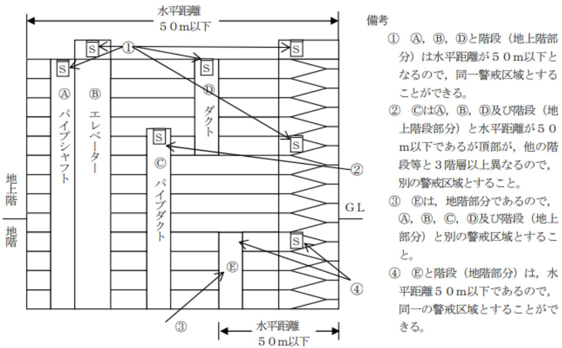
(3) 階段、傾斜路及びエスカレーターの警戒区域は、垂直距離45m以下ごとに1の警戒区域とし、かつ、地階と地上階は別の警戒区域とすること。（第24-6図参照）。ただし、地階の階数が1のものは、地上階と垂直距離45m以下で同一の警戒区域とすることができる（第24-7図参照）。
