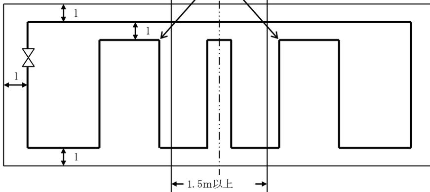
(ウ) 越屋根の構造が換気等の目的に使用されている場合は、熱の流通経路となる越屋根の周囲の部分に、1の感知区域となるように設けること(第24-90図参照)。
