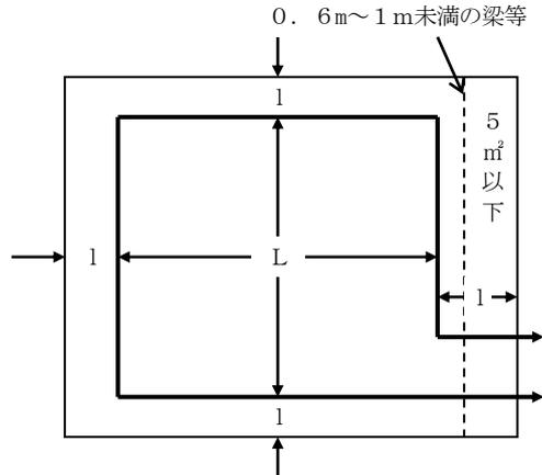
ウ 取付面の段違いの深さが、0.6m未満の場合は、同一の感知区域とすることができる（第24-73図及び第24-74図参照）。
