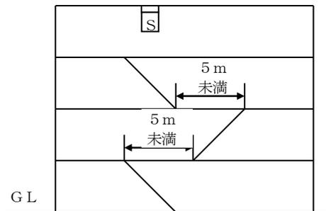
オ 開放式の階段、傾斜路又はエスカレーターには、規則第23条第5項第1号の規定にかかわらず、煙感知器を設けないことができる。ただし、開放式の階段、傾斜路又はエスカレーターで、上階への開口部が、火災時、煙の流通経路となるものは、その頂部に煙感知器を設けること。この場合に、当該煙感知器を設けた階は、当該煙感知器の感知面積の範囲内で、その階に設けるべき感知器を免除することができる。
