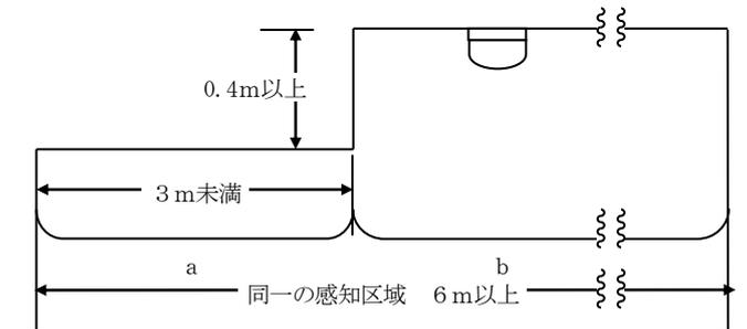
備考1 aとbの合計面積に必要な感知器の個数を高い天井面に設けること。
