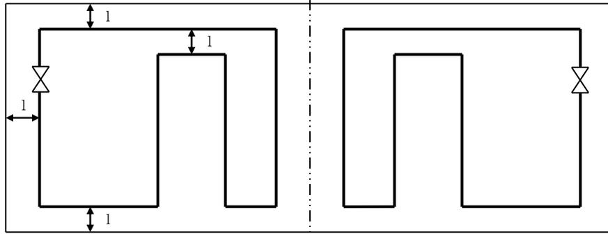
(イ) 越屋根の両肩の間隔が1.5m以上の場合は、越屋根の合掌部分を1の感知区域とし、両肩の部分にそれぞれ1本以上の空気管を設け、その他の部分は、傾斜角度が $3/10$ 以上の場合には、前カに規定する傾斜天井の例により設けること。(第24-89図参照)
