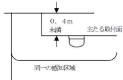
(イ) 段違いを含む居室等の幅が6m未満の場合は、段違いの形状にかかわらず、当該居室等を同一の感知区域とすることができる。この場合に、感知器は、当該居室等の面積に必要な感知器の個数を主たる取付面（同一の感知区域内で、取付面の高さが異なる部分が存する場合は、その取付面の高さに応じた面積のうち、最も広い部分の取付面をいう。以下この基準において同じ。）に設けること。ただし、段違いの高い部分の幅が1.5m以上である場合は、高い天井面に設けること（第24-29図、第24-30図及び第24-31図参照）。
