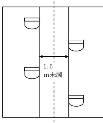
(イ) 越屋根の構造が換気等の目的に使用される場合は、第24-43図の例のように、感知器を熱の流通経路部分に、かつ、左右対称となるように設けること。
