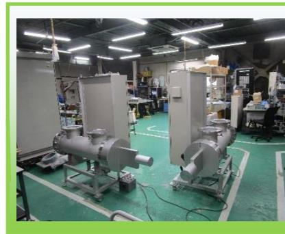
紫外線照射装置製作状況
